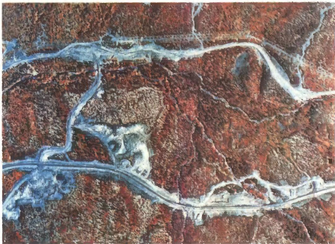
табе 1:5000, фиксирует ошибки проектировщиков, не предусмотревших возможность изменения теплового режима этого участка под действием газопровода. В результате после сооружения земляного полотна железной дороги в его основании активизировался термокарст и сооружение начало подтапливаться. Это создает аварийную обстановку и для железной дороги, и для газопровода. Печальный пример одной из разновидностей подобных ситуаций — катастрофа на железной дороге на перегоне Челябинск — Уфа.
